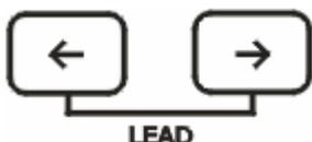
Presione la tecla para cambiar derivación en la función MANU.
